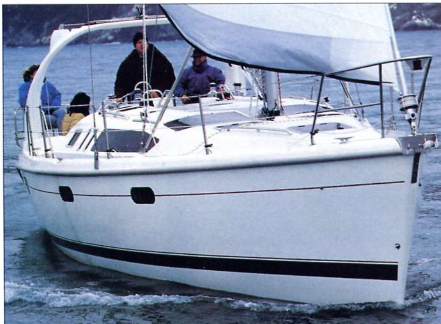
Le fiancate poco svasate dell'Hunter 380, ben evidenziate da questa immagine, conferiscono una elevata stabilità di forma e interni molto voluminosi.
